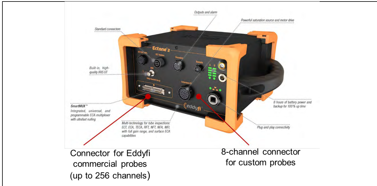
Figure 98. Ectane 2 system for EM NDE.
